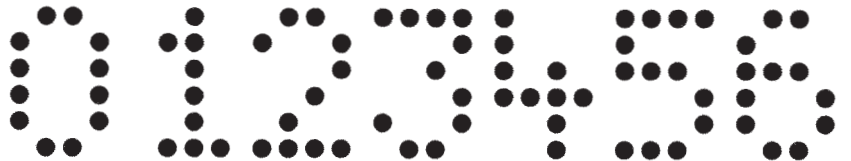
20 mm, 4 x 6 Punkte, Ø Nadel 2,3 mm
